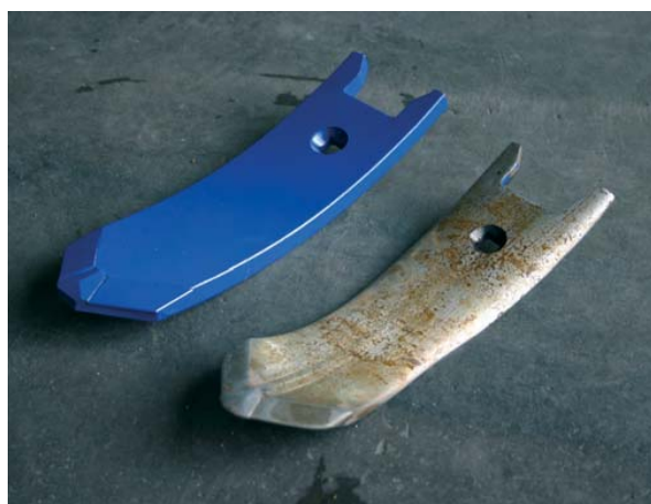
Eine Betek-Spitze neu (oben) und nach 240 ha (unten) auf stark abrasiven Böden (Einsatzbetrieb 2). Deutlich erkennbar ist der Verschleiß in der unteren Hälfte des Stahlkörpers, hinter den Hartmetallplättchen.
