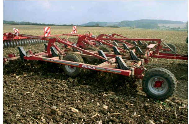
Der 7,5 m breite Grubber des Einsatzbetriebes 2 beim Bearbeiten von Maisstoppeln – bei einer Arbeitstiefe von ca. 15 cm liegt die Fahrgeschwindigkeit je nach Boden bei 8 bis 17 km/h.
