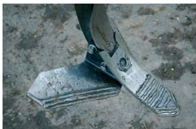
Selbst aufgepanzerter Verschleißteil erhöht zwar die Nutzungsdauer, allerdings auch den Zugwiderstand im Boden.
