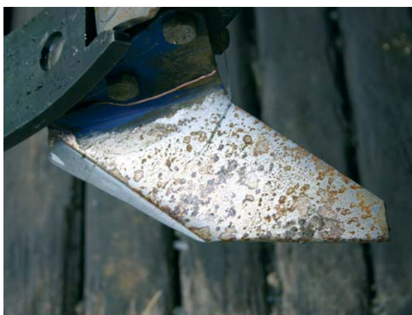
Ein BETEK-Flügel in erster Reihe nach 299 ha auf dem Einsatzbetrieb 1. Zwei der sechs Hartmetallplättchen sind bereits gänzlich verschlissen. In 2. und 3. Reihe war der Verschleiß zu diesem Zeitpunkt wesentlich geringer.
