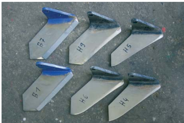
Standard-Flügel (H4-H9) und BETEK-Flügel (B1/B7) nach 80 ha auf dem Einsatzbetrieb 1
