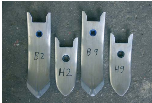
Standard-Spitzen (H2 & H9) und BETEK-Spitzen (B2 & B9) nach 80 ha auf dem Einsatzbetrieb 1
