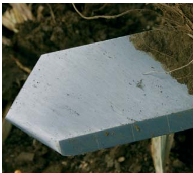
Ein BETEK-Scharflügel nach 1100 ha auf dem Einsatzbetrieb 2 – es ist kaum Verschleiß erkennbar.
