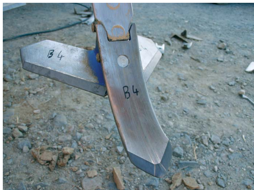
Ein komplett mit BETEK-Verschleißteilen ausgerüstetes Schar. Gut zu erkennen sind die 3 Hartmetallplättchen an der Spitze.
