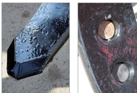
На рабочих органах Marathon хорошо видны напаянные на передние режущие кромки высокопрочные пластинки. Углубления – элемент, препятствующий стиранию и срыву головок болтов.
