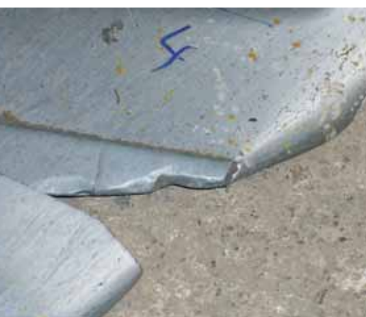
Durch Steine können vereinzelt Teile des Hartmetalls herausbrechen.
