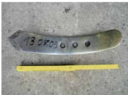
Beim Wechsel nach rund 450 ha hatten die Standardscharspitzen im Schnitt 7,4 cm Länge eingebüßt.
