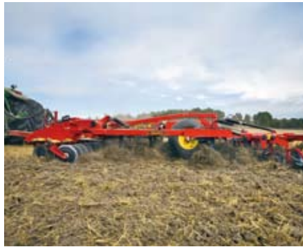
One-Pass-Geräte mischen und lockern mit verschiedenen Arbeitswerkzeugen.
