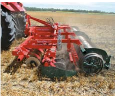
Kurzschneibeneggen arbeiten verschleißarm und sind unempfindlich gegen Steine.
