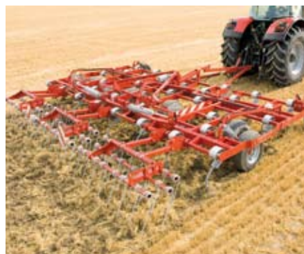
Mehrbalkige Grubber mit Gänsefußscharen eignen sich auch für den Stoppelsturz.
