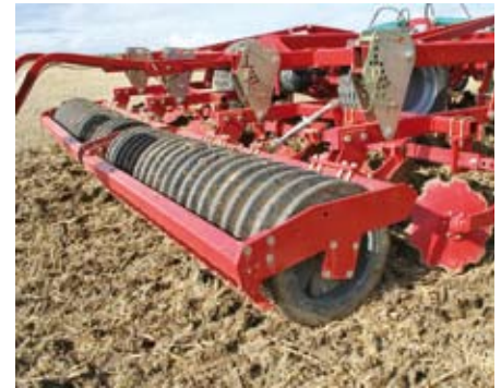
Geschlossene Walzen mit Keilringprofil bieten ein breites Einsatzspektrum.
