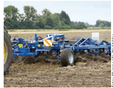
Mehrbalkige Aufsattelgrubber regulieren die Arbeitstiefen bis 35 cm vollhydraulisch.
