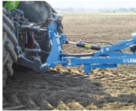
Hydraulische Zugkraftverstärker können die Kraftstoffeffizienz erhöhen.
