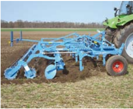
Gute Mischqualität bis 15 cm bieten Spezialschare am zweibalkigen Anbaugrubber.
