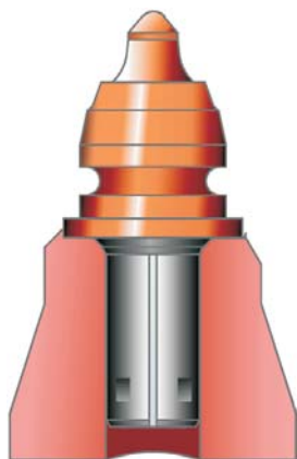
Рисунок износа после 530 ч использования резцов с удлинённой »R«-гильзой
