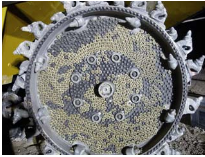
Abb. 3: Fertig bestückte Fräswalzen-Seitenfläche (Foto: BETEK)
