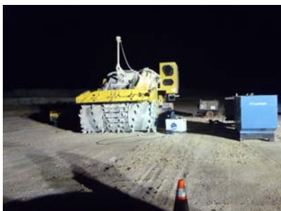
Abb. 2: Rund um die Uhr im Einsatz: Der Terrain Leveller mit TungStuds Bestückung (Foto: BETEK)
