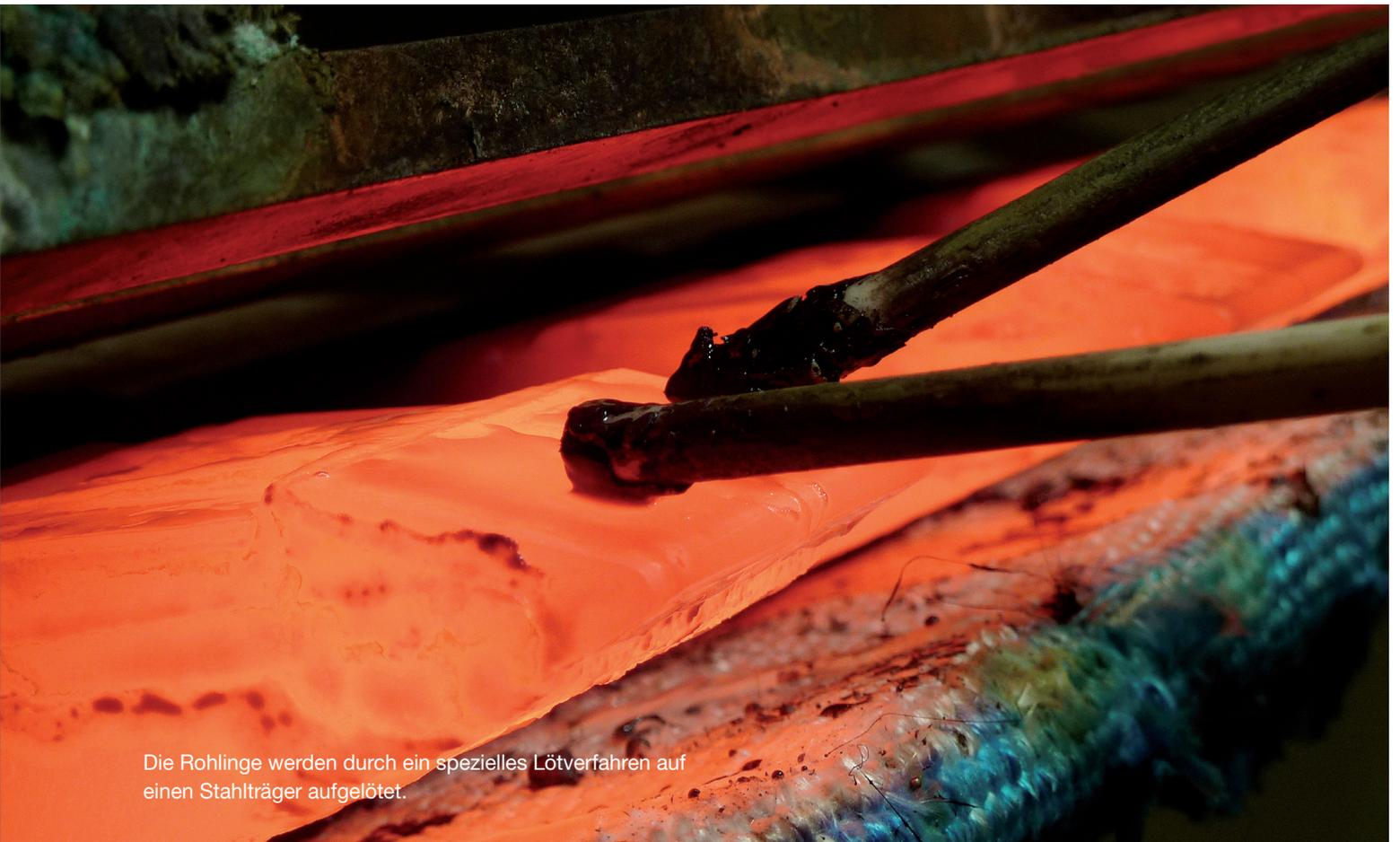
Die Rohlinge werden durch ein spezielles Lötverfahren auf einen Stahlträger aufgelötet.
